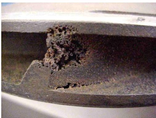
Abb. 85: Überlastkavitation im Austrittsbereich einer Laufradschaufel
