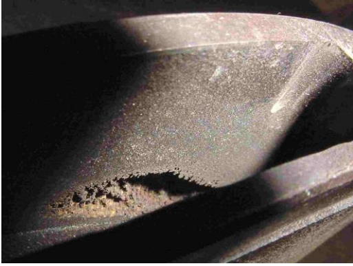
Abb. 86: Überlastkavitation in einem Kanal eines Laufrades
