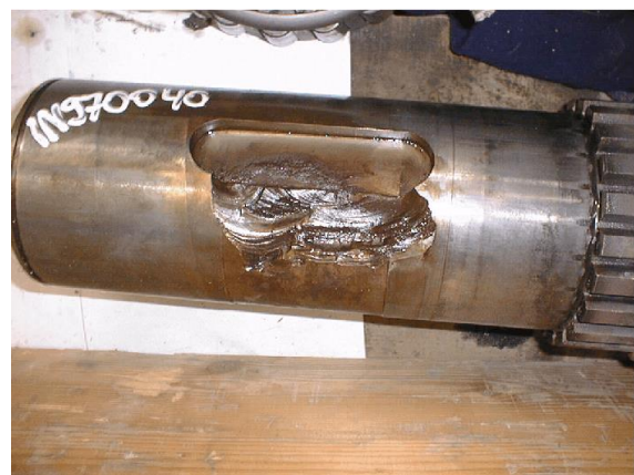
Abb. 89: Ausbruch einer Passfedernut
