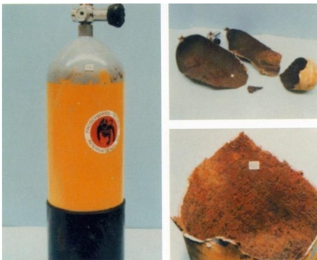
Abb. 27: Gleichmäßige Flächenkorrosion an einer Preßluft-Tauchflasche → Rostbildung
