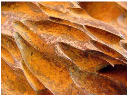
Abb. 79: starke, durch Chloride ausgelöste und hohe Feststoffkonzentration beschleunigte Erosionskorrosion am Gehäuse einer Panzerpumpe aus gehärtetem Stahlguss
