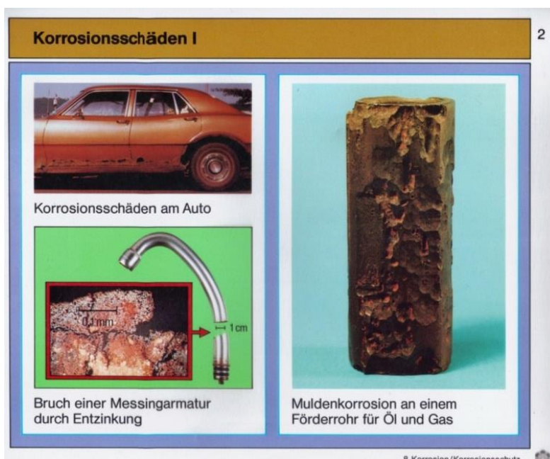
Abb. 1: Erscheinungsbilder einiger Korrosionsarten, Näheres s. VL.
