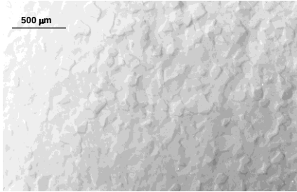
Abb. 34: Al 99,99: elektropolierte Oberfläche \rightarrow Lochbildung (Lfr) links Ausgangsoberfläche (elektropoliert, s.u.); rechts Lfr durch \text{Cl}^- Ionen (LIM) Die nächsten Bilder zeigen REM-Aufnahmen von Rein-Al-Proben.
